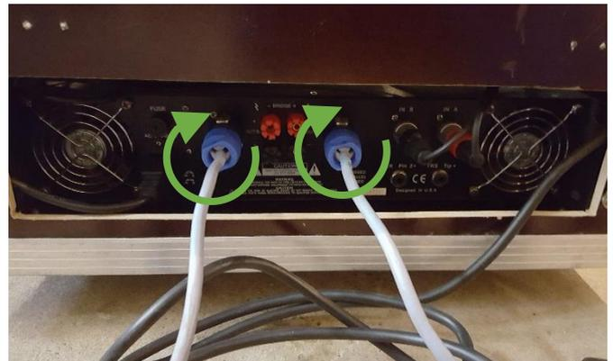
Die Boxenkabel etwas nach rechts drehen bis diese verrasten bzw. verriegeln.
