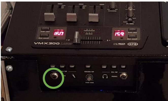
Das Mikrofon kann über den vorh. Anschluss einfach ans Mischpult angeschlossen werden.
