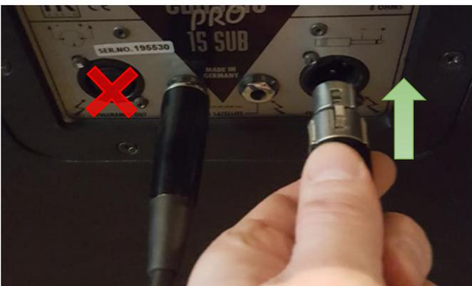
Jetzt das Boxenkabel mit dem Subwoofer verbinden. Das Kabel soweit in den Anschluss drücken bis Verriegelungsgeräusch ertönt.
