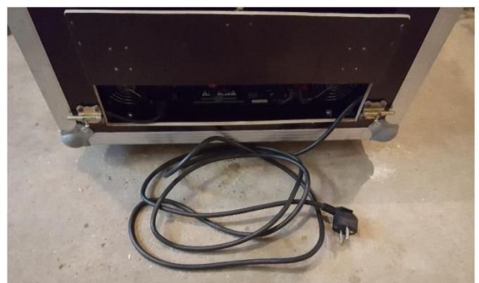
Jetzt kann das Netzkabel an eine normale Steckdose angeschlossen werden, wobei die Steckdose mit einer üblichen 16 Amper Sicherung abgesichert sein sollte.
