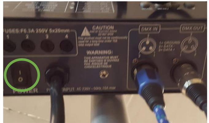
Nachdem die beiden Netzstecker der Lichttürme in eine 230V Steckdose eingesteckt wurden können die beiden Netzschalter eingeschaltet werden.
