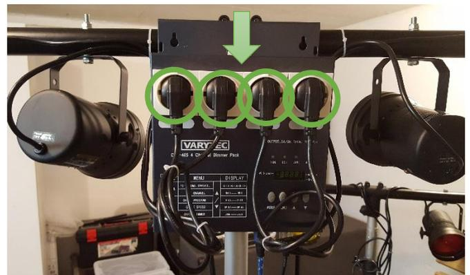
Lichtsteuerung von hinten und mittig auf den Ständer aufsetzen und die 4 Netzstecker der Lampen einstecken
