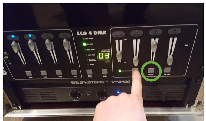
Um die Lichter zu testen auf der rechten Seite der Lichtsteuerung die Taste FULL ON drücken.
