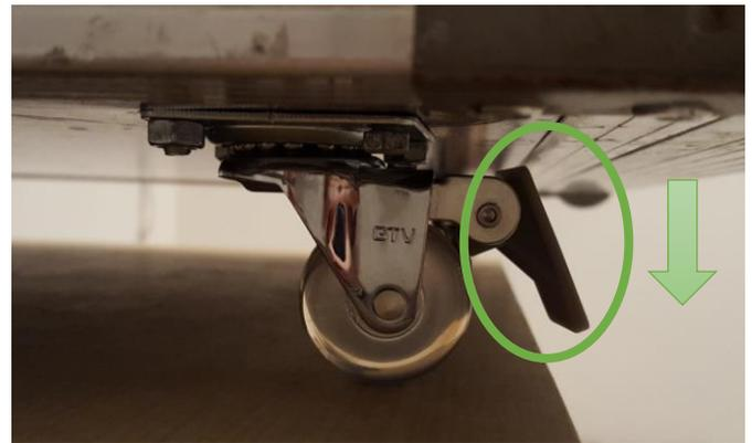
Damit das Winkelrack nicht wegrollen kann muss zwingend die Bremse der beiden vorderen Rollen verriegelt werden.
