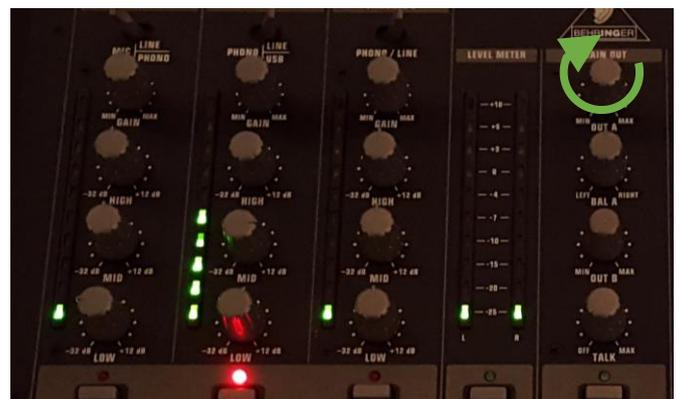
Main Out → 1. Regler OUT A langsam nach rechts drehen um Lautstärke zu erhöhen.
