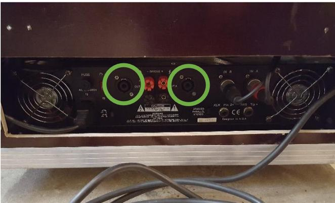
Die beiden Boxenkabel mit der passenden Anschlussseite in die schwarzen Buchsen (CH1 und CH2) des Verstärkers einstecken.
