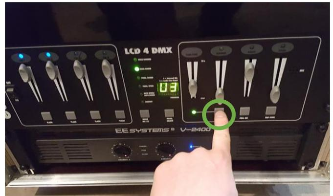
Jetzt an der Lichtsteuerung des Winkelrack den Taster **STANDBY** drücken, damit die Lichtsteuerung aktiviert wird.
