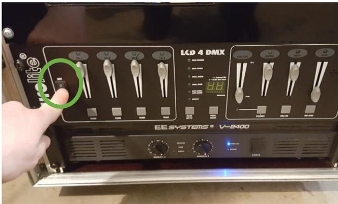
Lichtsteuerung am Winkelrack auf der Vorderseite des Racks einschalten
