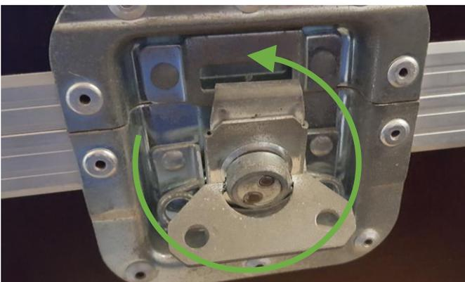
Die vordere und obere Abdeckung kann jetzt abgenommen werden. Hierzu müssen die vier Drehverschlüsse geöffnet werden.
