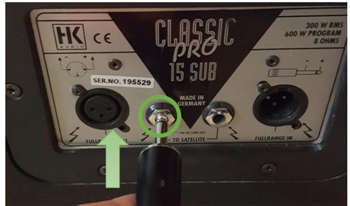
Danach die andere Steckerseite des Kabels mit dem Subwoofer verbinden.
