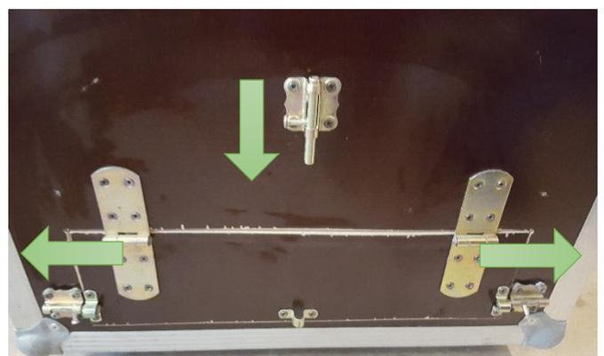
Für den Anschluss der Boxenkabel muss die hintere Abdeckung geöffnet werden. Hierzu die beiden seitlichen Sicherungen öffnen und danach die Abdeckung mit der oberen Sicherung fixieren.
