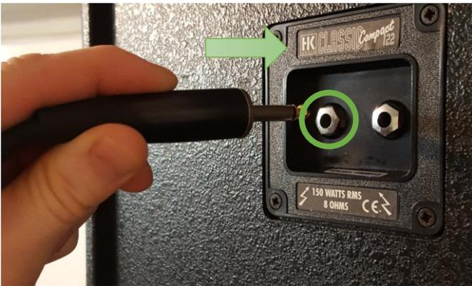
Das 6,3 Klinke Kabel (3 Meter) als erstes mit dem Speaker verbinden.
