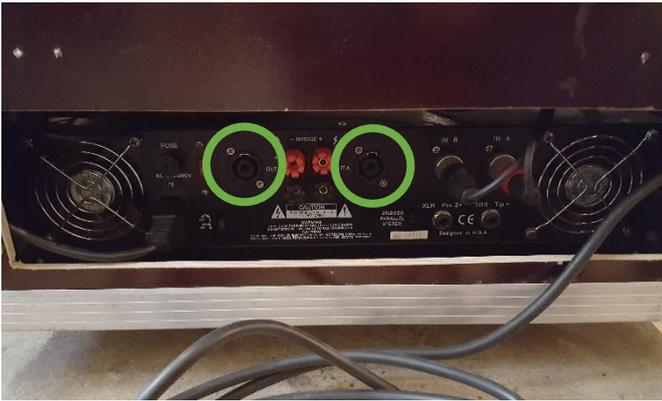
Dier beiden Boxenkabel mit der passenden Anschlussseite in die schwarzen Buchsen (CH1 und CH2) des Verstärkers einstecken.
