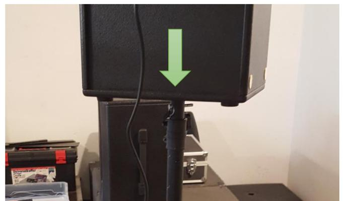
Danach kann der Speaker auf die Verbindungsstange aufgesetzt werden. Es ist darauf zu achten, dass der Speaker sicher und stabil mit der Verbindungsstange verbunden ist.
